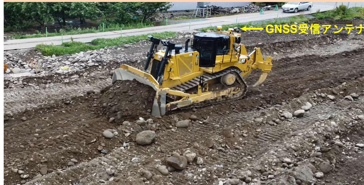
3D仕様建設機械の導入により、仕上げ整地の効率、精度、生産性を高めることができる。また、グレードコントロールシステムで、繊細な仕上げ整地や押土作業において、ブレードの動きを自動化することで、オペレータによる手動操作入力を80%軽減します。
