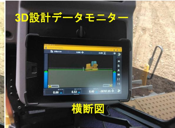
オペレータは、運転席に設置されたモニターで平面位置、仕上げ高さをリアルタイムで確認し、効率的かつ正確に整地作業を実施する。
