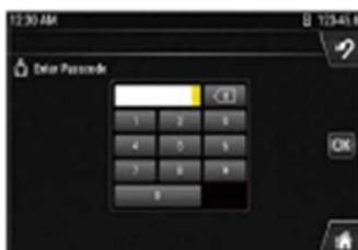
モニタ画面にパスコードを入力しエンジン始動を行う仕組みです
